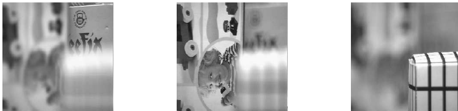
Bild 3: Bilder der komplexen Szene, bei der der zur Fokussierung verwendete Bildausschnitt drei Objekte in unterschiedlichen Tiefenbereichen enthält. In den drei Bildern sind Fokusmotorpositionen angefahren, die jeweils ein Objekt scharf abbilden.
