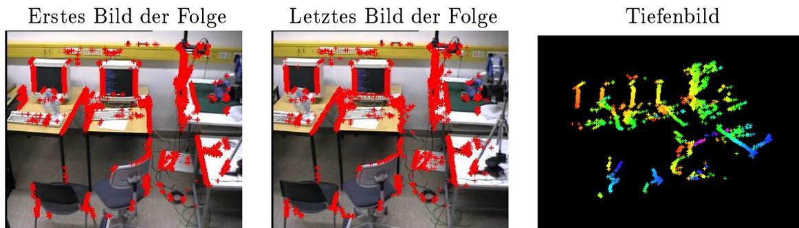
Bild 3: Punktverfolgung in Farbbildern bei bekannter Bewegungsrichtung; die Farbcodierung der Tiefenwerte entspricht der aus Bild 2.
