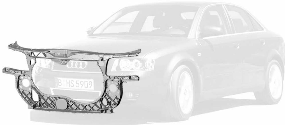
**Bild 1:** Anwendungsfeld der Hybridtechnik als PKW Front-End-Modul am Beispiel des Audi A4 (Quelle: Audi AG)
