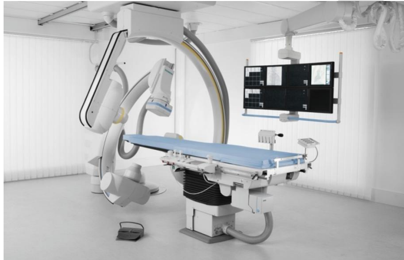
Abb. 2: Beispiel eines C-Bogenbiplansystems (Artis zee biplane system, Siemens AG, Healthcare Sector, Forchheim, Deutschland).
