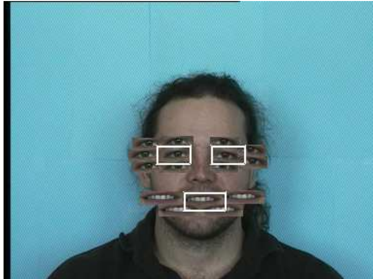
Bild 13: Demonstration der Robustheit von gekoppelten Strukturen gegenüber hochgradigen Störungen und Mehrdeutigkeiten. Im Beispiel werden die räumlichen Abhängigkeiten der Gesichtsmarkale Augen und Mund durch drei koppelnde Strahlen modelliert.
