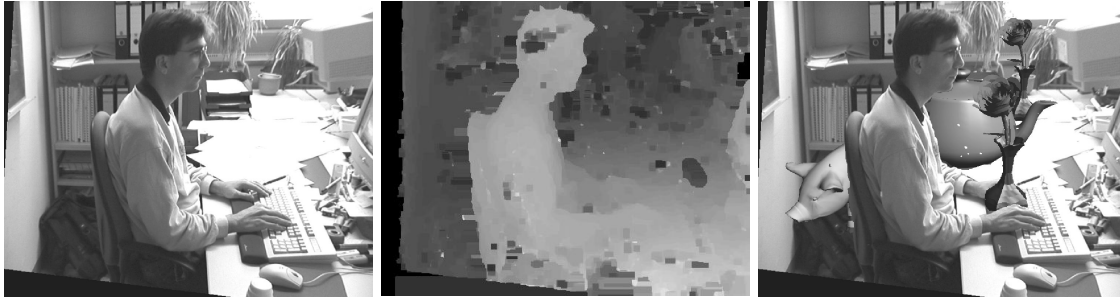
Bild 1.1 Beispiel für Erweiterte Realität: In das linke Bild sollen drei künstliche Objekte eingefügt werden. In der Mitte ist eine sog. Tiefenkarte dargestellt, die für jeden Bildpunkt die Tiefe als Grauwert darstellt. Dies ist notwendig um Verdeckungen richtig zu berechnen. Das Resultat ist rechts zu sehen. Bildquelle: [Vog01, Sch02].
