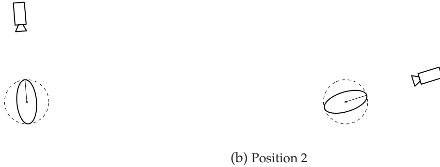
Bild C.1 Der Punkt wird mit Hilfe des Kalman-Filters analysiert. Die Unsicherheitsellipse der a priori Kovarianzmatrix (in diesem Fall die Einheitsmatrix) ist ein Kreis (gestrichelt). Unabhängig davon, von wo eine weitere Beobachtung gemacht wird, die Unsicherheit im Sinne der E-Optimalität bleibt immer gleich dem Radius des Kreises, da die Unsicherheit in die Richtung der z-Achse der Kamera nicht abnehmen kann.
